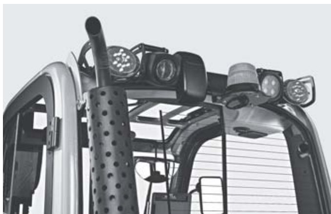
Plus de sécurité grâce au Safety Light 4Plus et à l'éclairage LED
