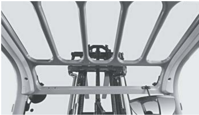
Visibilité optimale grâce aux profilés étroits des montants du toit de protection
