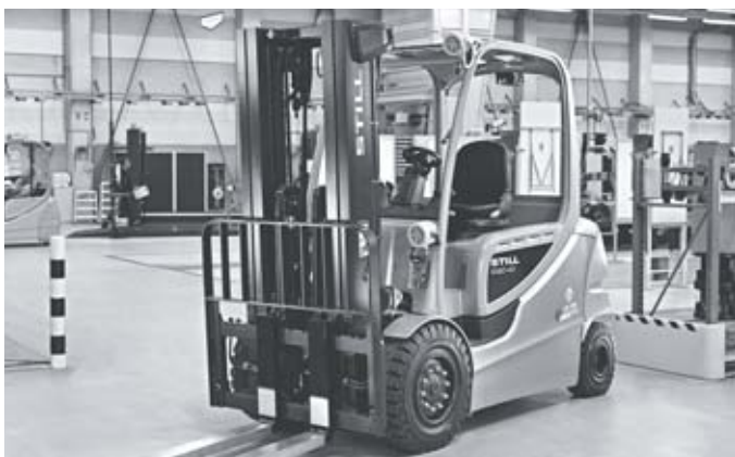
Exécution antidéflagrante avec composants électriques encapsulés
