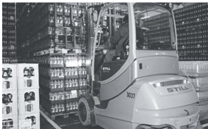
Bonne visibilité au-dessus des charges hautes (surélévation du poste de conduite)
