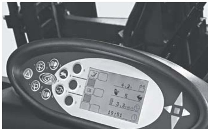
Affichage centralisé de la consommation d'énergie et d'autres informations de conduite
