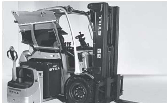
Changement de batterie latéral simplifié : utilisation d'un transpalette et d'un châssis d'échange batterie
