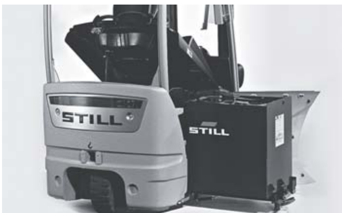
Possibilité de remplacement latéral de la batterie à l'aide d'un palan ou d'une grue
